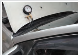
• Liga o manómetro facilmente à cobertura do motor.
